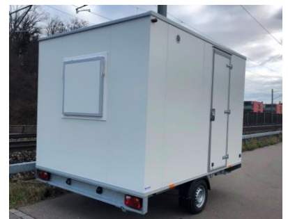
Fenster mit Deckel verschlossen
