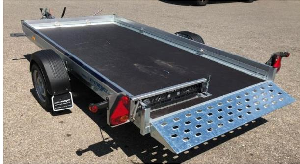
Tieflader mit nach hinten absenkbarer Ladefläche mittels mechanischer Handhydraulikpumpe. Verschweisster und feuerverzinkter Chassisrahmen, verschraubter V-Deichsel, Auflaufbremsen mit Rückfahrautomatik, verzinkte Gummifederachse. Bereifung 195/50R 13C. Kunststoffkotflügel, Radkeile, Stützrad. Beleuchtung 12 Volt mit 13-poligem Stecker.
