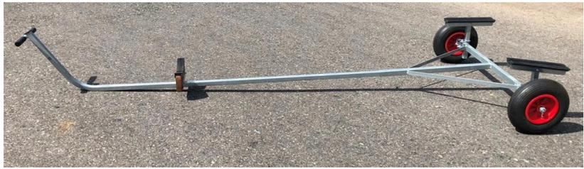
Schwere Baureihe aus feuerverzinkten Stahlprofile, 2fach zerlegbar, Räder 400x100mm. Für Boote bis 5.0m Länge, Zuladung bis 140kg. Hinten zwei Langauflagen, seitlich verstellbar. Vorne V-Auflagen mit Profilgummi, Innenlänge ca. 320cm, Abstand der Langauflagen ca. 110cm
