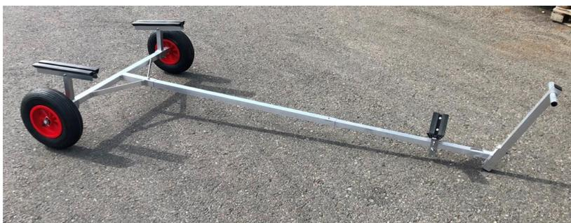
Leichte Baureihe aus Aluminiumprofile, 4fach zerlegbar, Räder 400x100mm. Für Boote bis 5.0m Länge, Zuladung bis 130kg. Hinten zwei Langauflagen, seitlich verstellbar. Vorne V-Auflagen mit Profilgummi, Innenlänge ca. 250cm, Abstand der Langauflagen ca. 110cm
