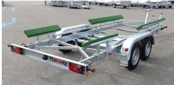
**Fischerbootanhänger**, vorne und hinten je 2 seitliche Führungsrollen, höhenverstellbar. Vorne 2 Laufrollen verstellbar. Chassisrahmen wird dem Boot/Zille, angepasst, Einzelanfertigungen. Links und rechts auf
