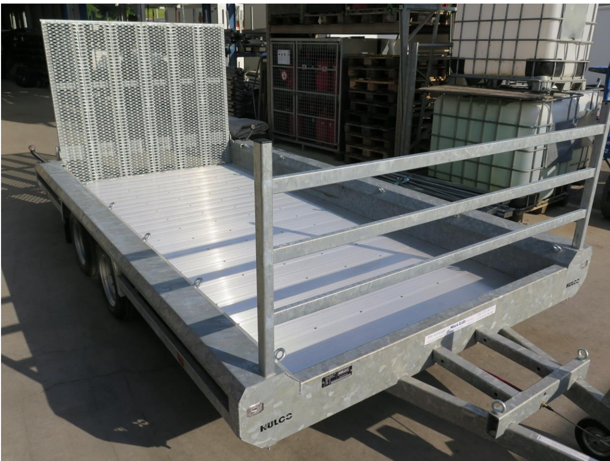
TX 4018 GG 3500kg 394 x 180 x 27cm, Vordergitter verschweisst und feuerverzinkt
