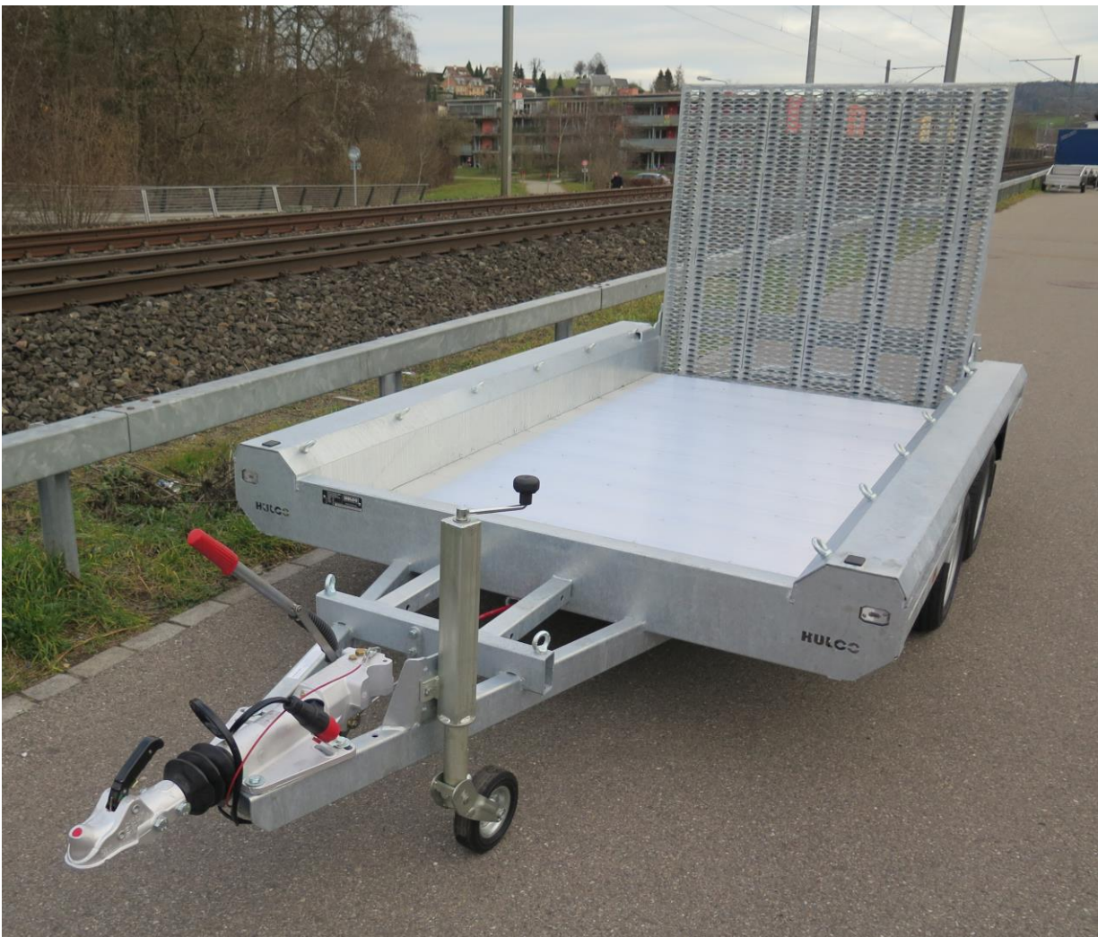
TX 3015 GG 3500kg 294 x 150 x 27cm, Aluprofilboden, Schaufelablage, Bänderinge
