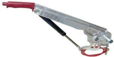
**Handbremshebel ALKO Unteneinbau**
