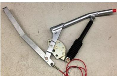
**Handbremshebel ALKO Gasfeder 603896**
