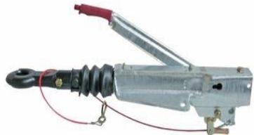
**Auflaufeinrichtung ALKO 251/G Sta für V-Deichsel 1500-3000kg DIN-Zugöse, Stützlast 100kg, oben Einbau. Nr. 249 250 / ETI 811226, kombinierbar mit ALKO Radbremse V-O 1637/2051. Lochbild 120 / 166 / 166-217mm.**
