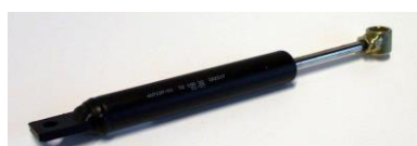
Auflaufdämpfer Peitz, PAV/SR-2.7, Gesamtlänge 235mm, Rohrlänge 155mm, Durchmesser 24mm Miet-Lift Art.Nr. 53420
