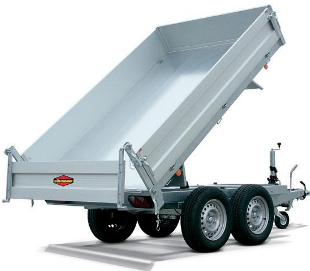
Rückwärtskipper RK-AL 3016/30, 306 x 165 x 35cm, Hand- und Elektropumpe kombiniert
