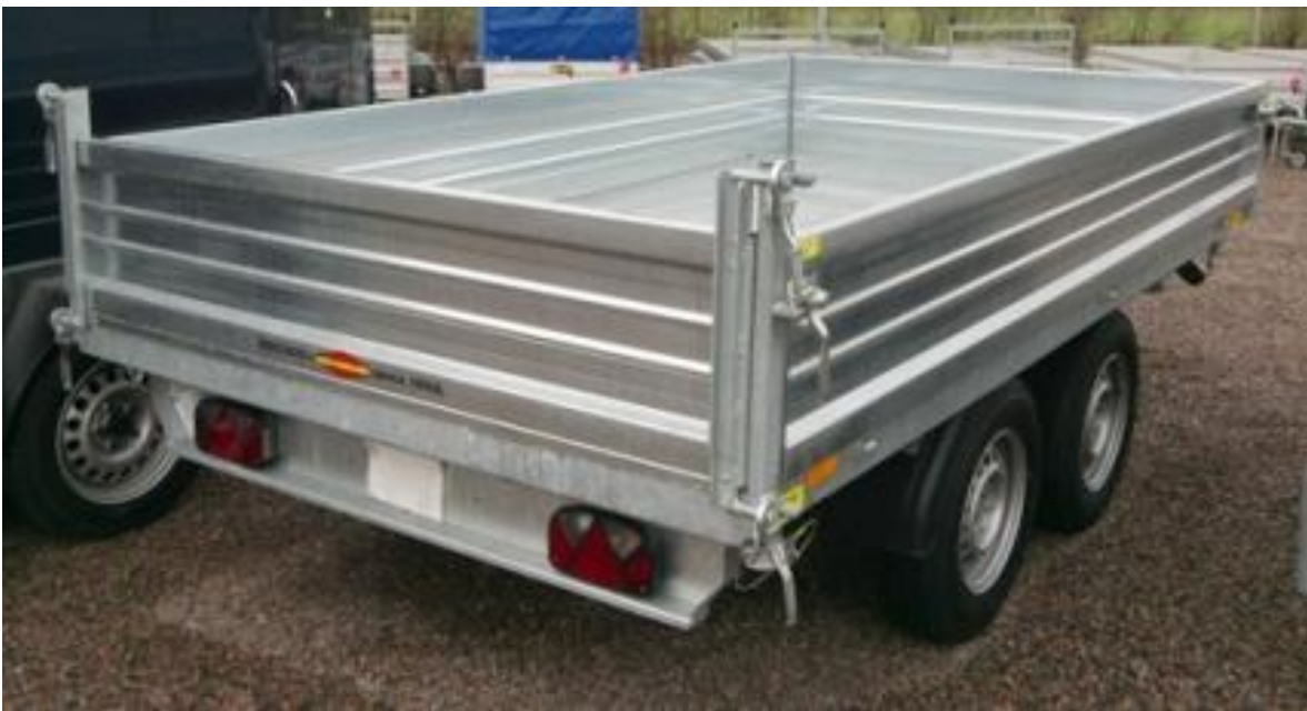
Heckansicht 3-Seitenkipper, Pendelklappe hinten, Stahlblechboden
