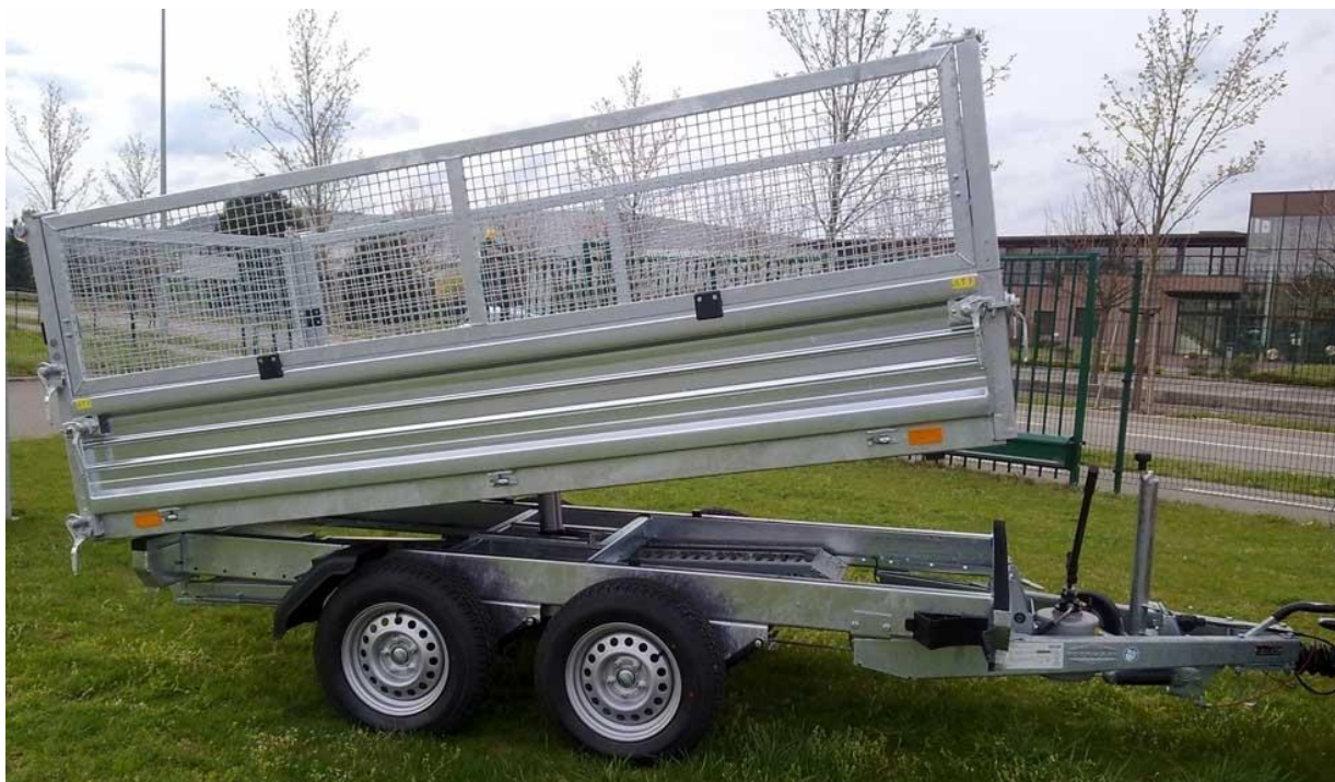
3-Seitenkipper DK 3318/35, 324 x 180 x 40cm, Stahlbordwände und Laubgitter + 60cm, feuerverzinkt
