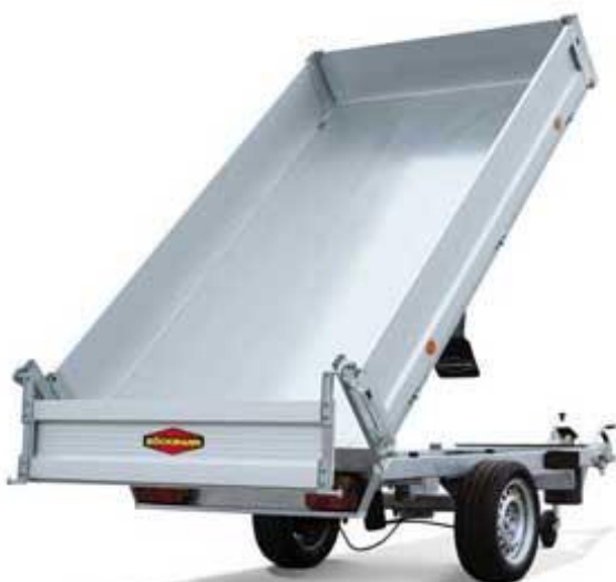
Rückwärtskipper RK-AL 2514/15, 246 x 140 x 30cm, Handpumpe, Aluminiumbordwände
