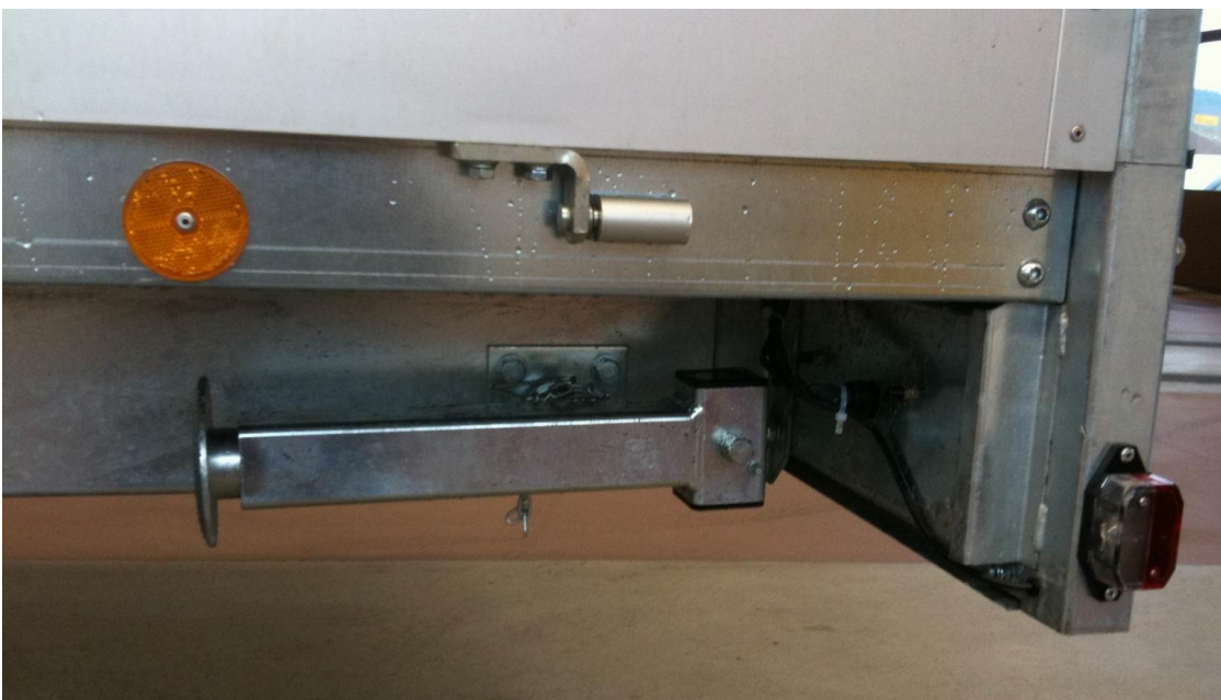
Abdrehbare Kurbelstützen seitlich am Längsträger angebracht
