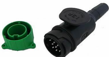
Stecker Kunststoff 13-polig 12 V Bajonetverschluss (keine drehbare Aussenhülle) mit 13 Schraubanschlüssen Ausgangsdichtung für 2 Rundkabel
