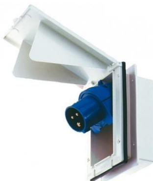
Eingangssteckdose 230 Volt, 16 A, Typ 250 mit ausklappbarem Deckel. Gehäusemasse: Länge 135mm, Breite 70mm, Höhe 55mm. Deckelmasse: Länge 160mm, Breite 105mm, Höhe 14mm.
