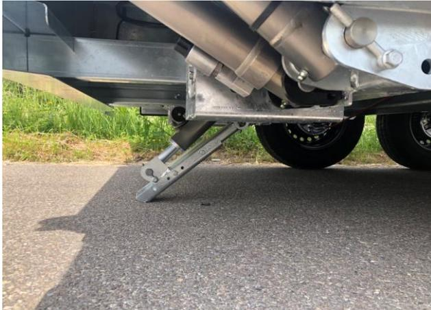
Hydraulischer Stützfuß hinten
