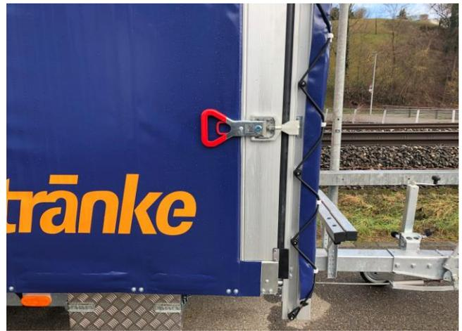
Schiebeblende seitlich, oben und unten mit Rollen geführt, Verschlüsse abschliessbar
