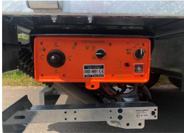
Steuerkasten für Hebebühne, abschliessbar
