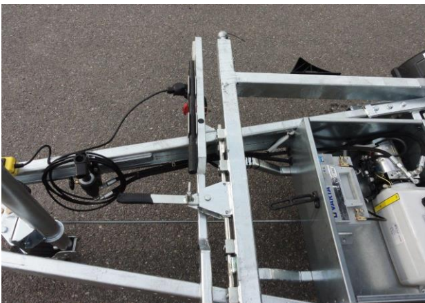
Entriegelungshebel, Hydraulikpumpe in Behälter
