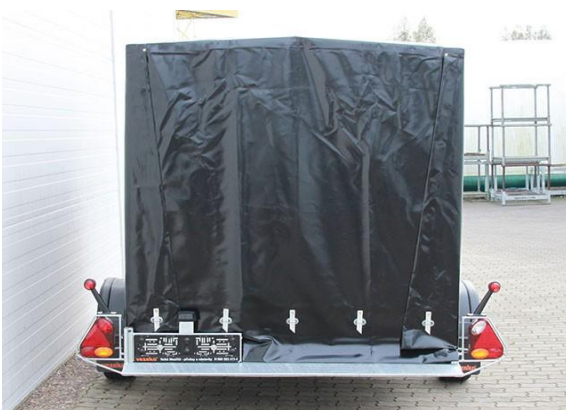
Blachenaufbau, hinten ohne Rückwand mit Anfahrkeil
