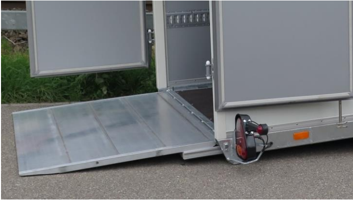
Rampe in Sonderausführung, Traglast 1000kg mit Anfahrspitz (Mehrpreis)
