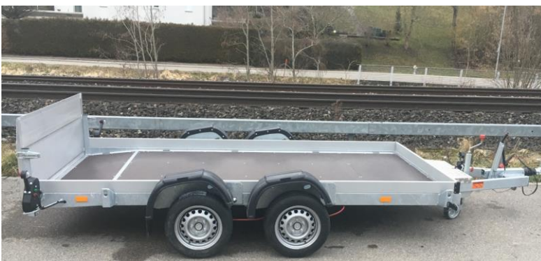
Boden hinten angeschrägt, 60cm Aluminiumrampe 1000kg belastbar, Boden verstärkt für Beladung von Kleinstapler
