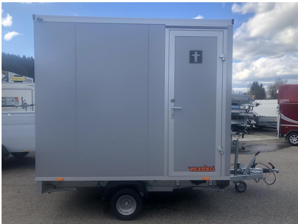
Toilettenanhänger 2 Kabinen, 1- Achser mit Wasserspülung
