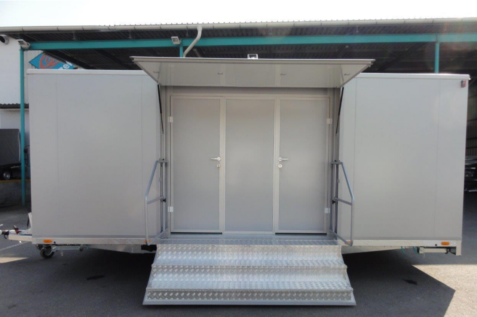
Toilettenanhänger mehrere Kabinen, Tandemachser mit Wasserspülung
