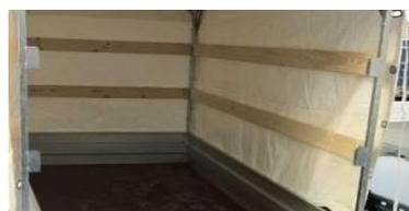
**Holzlatte für Blachenaufbau 116x25mm**
