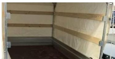
**Holzlatte für Blachenaufbau 116x25mm**
