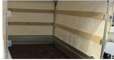
**Holzlatte für Blachenaufbau 116x25mm**
