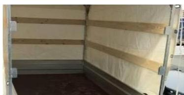
**Holzlatte für Blachenaufbau 116x25mm**
