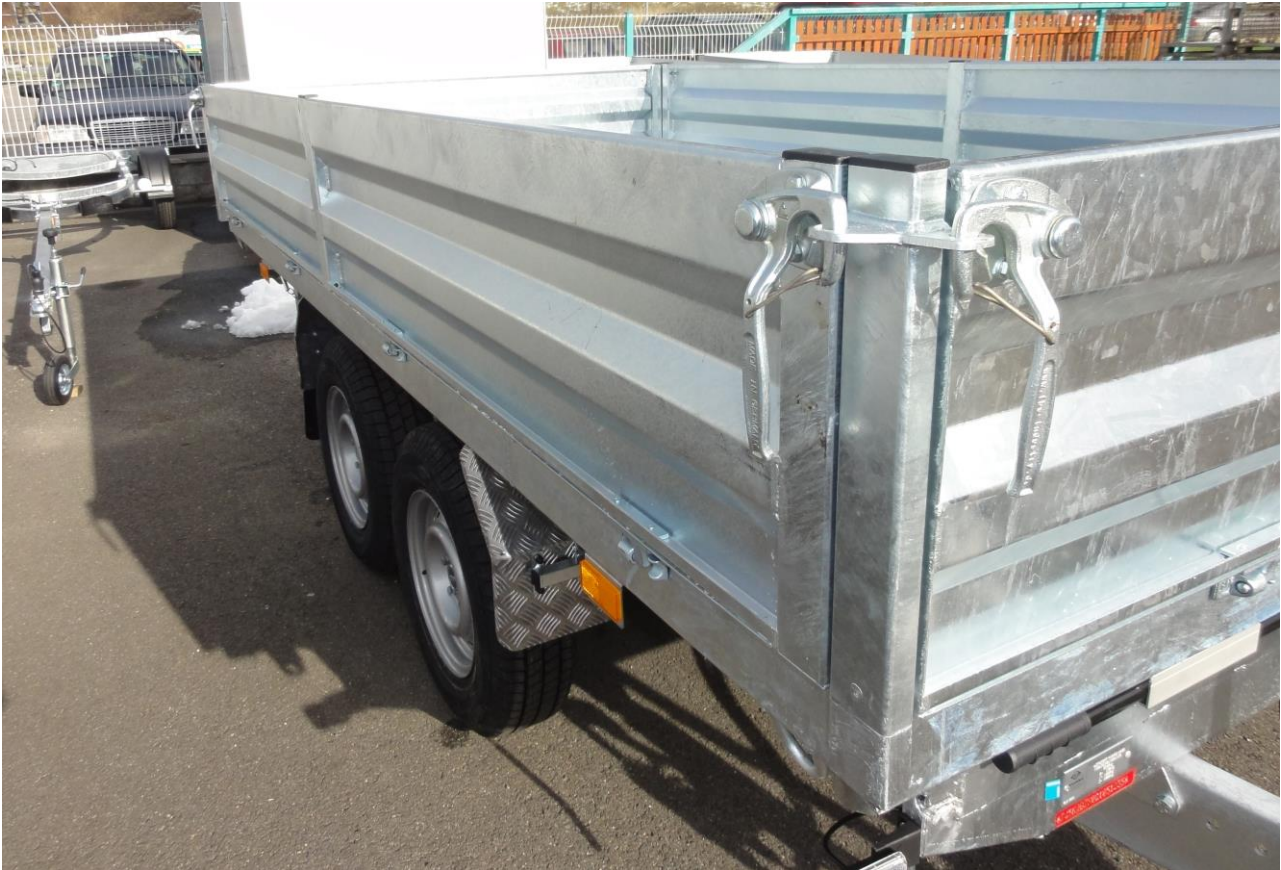
Stahlprofilwände feuerverzinkt 40cm statt Aluminiumwände, Winkelhebelverschlüsse
