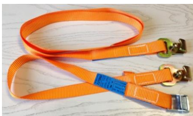
Zurrgurt für Stäbchenzurrtschiene 2-teilig mit Klemmschloss. Bandbreite 25mm, L 2m, Direktzug 125kg / Umreifung 250kg. Miet-Lift Art.Nr. 58098
