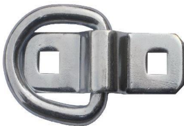
Zurrbügel mit Grundplatte Anschraubplatte mit schwenkbaren D-Bügel Platte bündig montierbar Abm. 60/16mm, Zugkraft 5000kg
