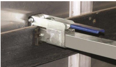
Klemmlatte aus Stahl verzinkt (Sperrlatte) mit Klemmhebel, Klemmbereich 8-54mm. Für Fahrzeugbreite von 114cm bis max. 271 cm Länge. Spannweite stufenlos verstellbar mit Druckknopf. Haltekraft bis maximal 1250daN. Profil 45x45mm. Miet-Lift Art.Nr. 58174
