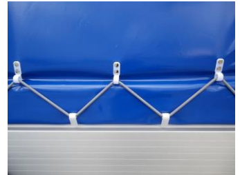
Blachenbefestigung an Bordwand
