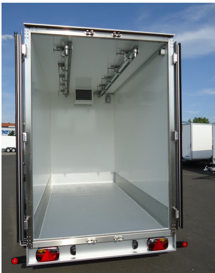
AZK mit 2 Fleischrohrbahnen, Innenhöhe 220cm
