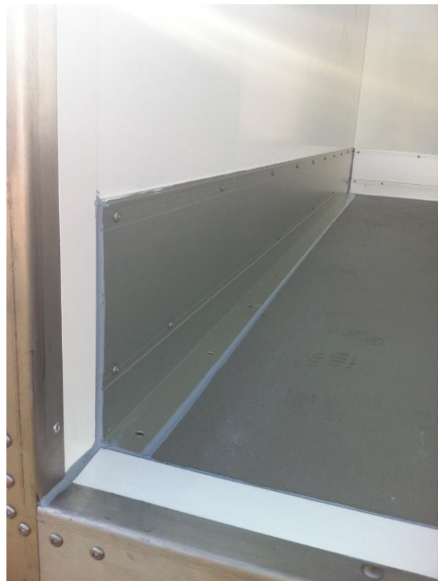
AZK Chomstahlrahmen, Bodenbesandet, Alurammschutz 25cm hoch
