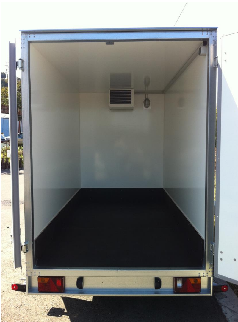
AZKF : Siebdruckboden, seitlich Siebdruck-Rammschutzsteifen 25cm hoch Boden, Wände, Dach und Türen 60mm isoliert
