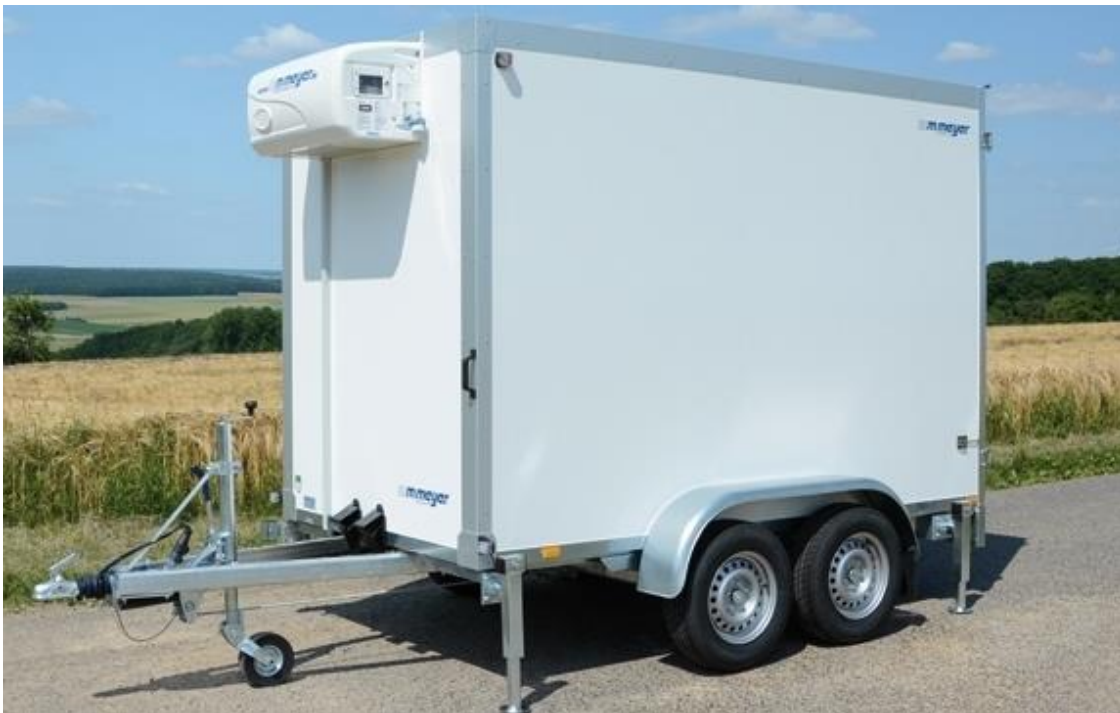
AZKF 2730/155, GG 2700kg 295 x 154 x 200cm, Kurbelstützen statt Schwerlaststützen
