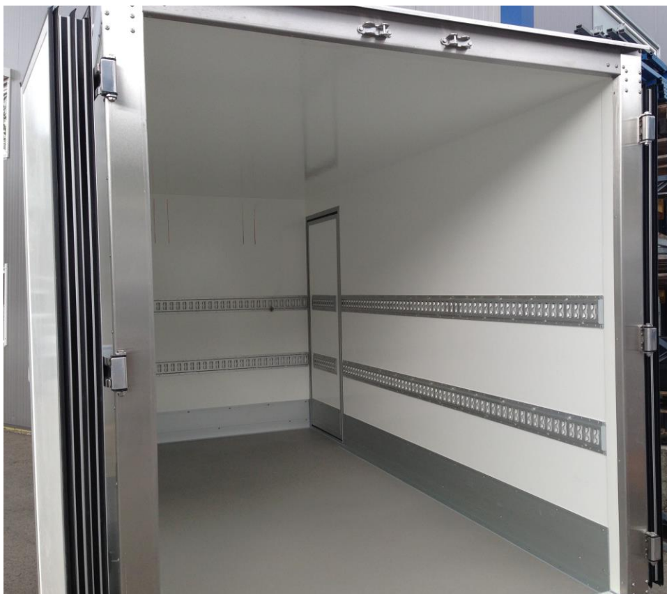
AZK 100mm Wände, Loch-Schlitzbindeschienen, Seitentüre
