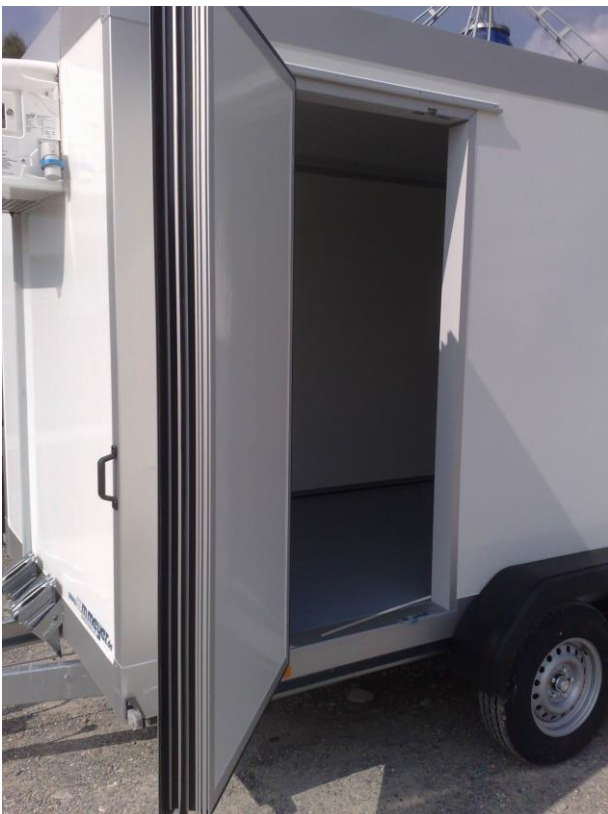
AZK Iso-Wände 100mm, mehrlippige Türdichtung
