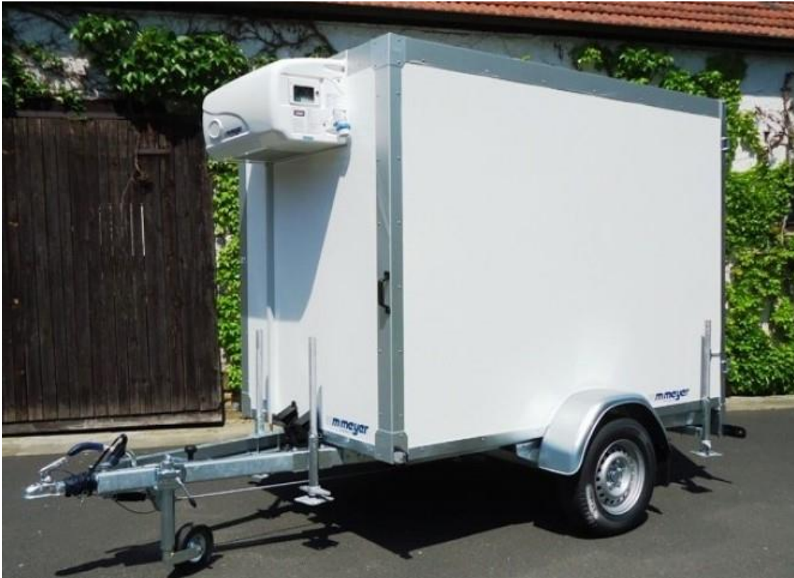
AZKF 1525/145, GG 1500kg 244 x 144 x 180cm, 4 Schwerlaststützen
