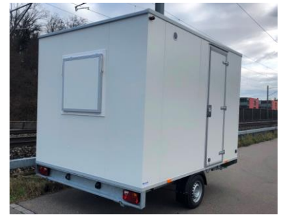
Fenster mit Deckel verschlossen
