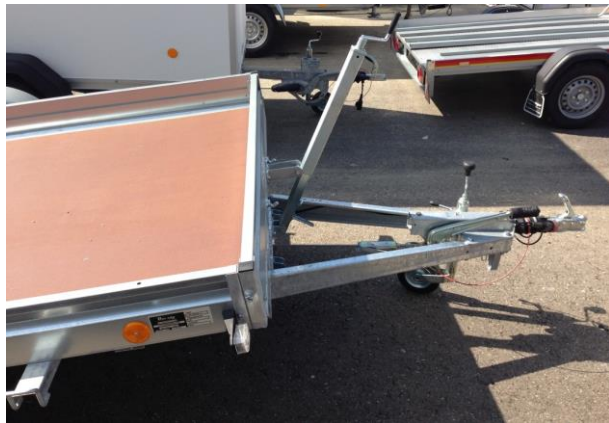
Spindelkurbel zum Heben und Senken der Brücke
