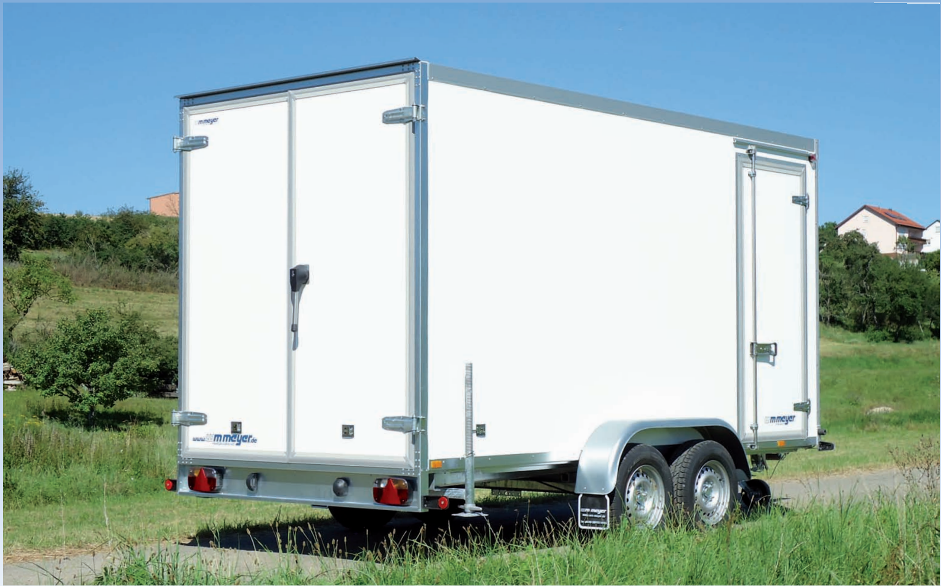
AZKF 2740/180 4 Schwerlaststützen, Kühlzellenverschluß, Zubehör: Seitentür AZKF 2740/180 4 béquilles renforcées, fermeture de cellule frigorifique, option : porte latérale AZKF 2740/180 4 reinforced prop stands, coldroom closing system, optional extra: side door
