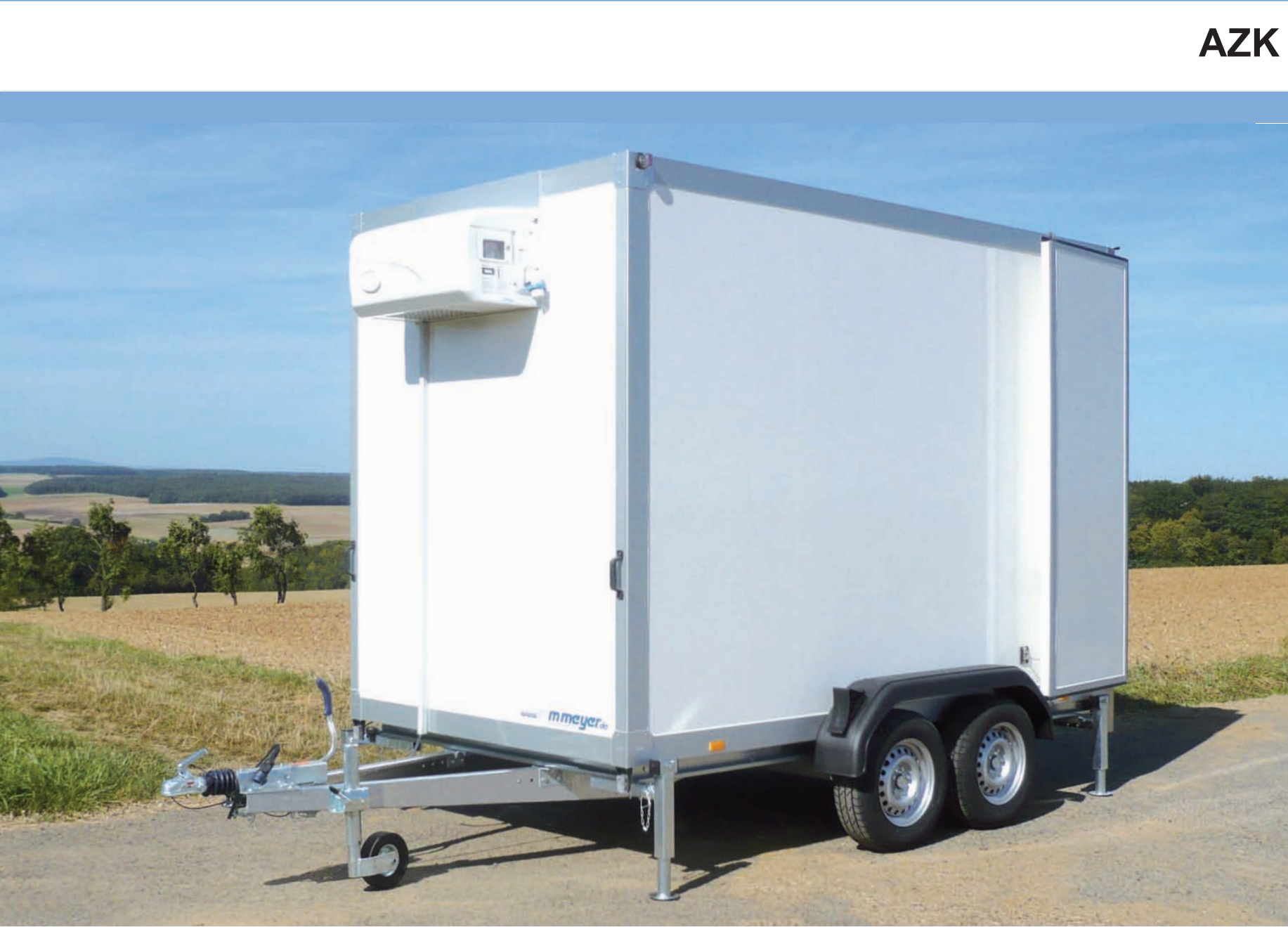
AZK 2734/180 60/60 K Aluminiumprofile, Zubehör: 4 Klappkurbelstützen mit Kurbel, Kühlung WMK 4 AZK 2734/180 60/60 K Profilés en aluminium, options : 4 béquilles à relever avec manivelle, groupe froid WMK 4 AZK 2734/180 60/60 K Aluminium profiles, optional extras: 4 prop stands to be folded away with crank, freezer unit WMK 4
