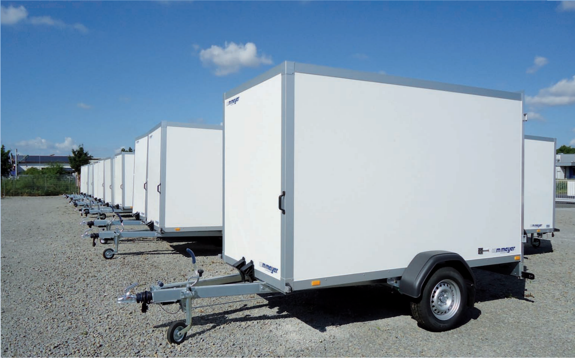
AZ 1330/151 Serie 30 Zubehör: 100-km/h-Ausführung AZ 1330/151 Série 30 Option : kit « Rouler plus confortablement » AZ 1330/151 Series 30 Optional extra: smooth-ride kit
