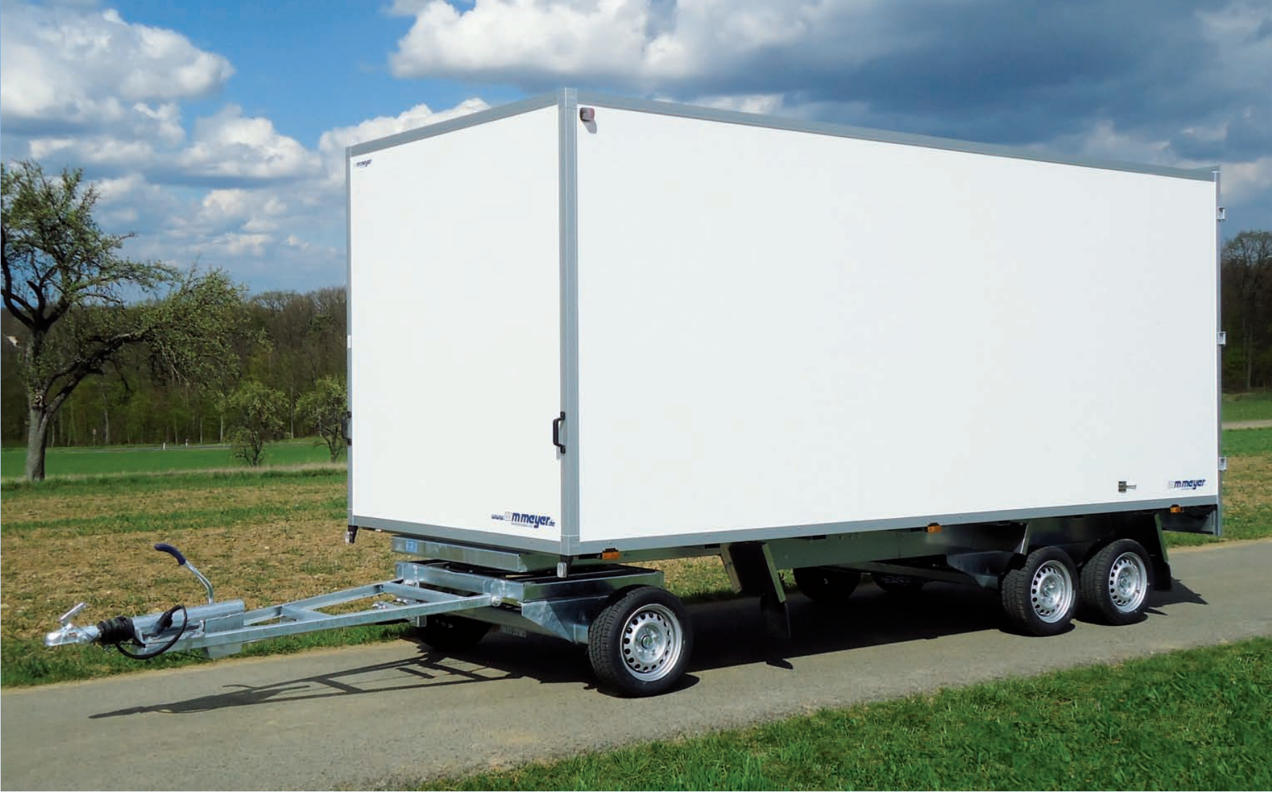
DSH-AZ 3550/210 Aufbau Sandwichpolyester DSH-AZ 3550/210 Panneaux en polyester sandwich DSH-AZ 3550/210 Panels made of sandwich polyester
