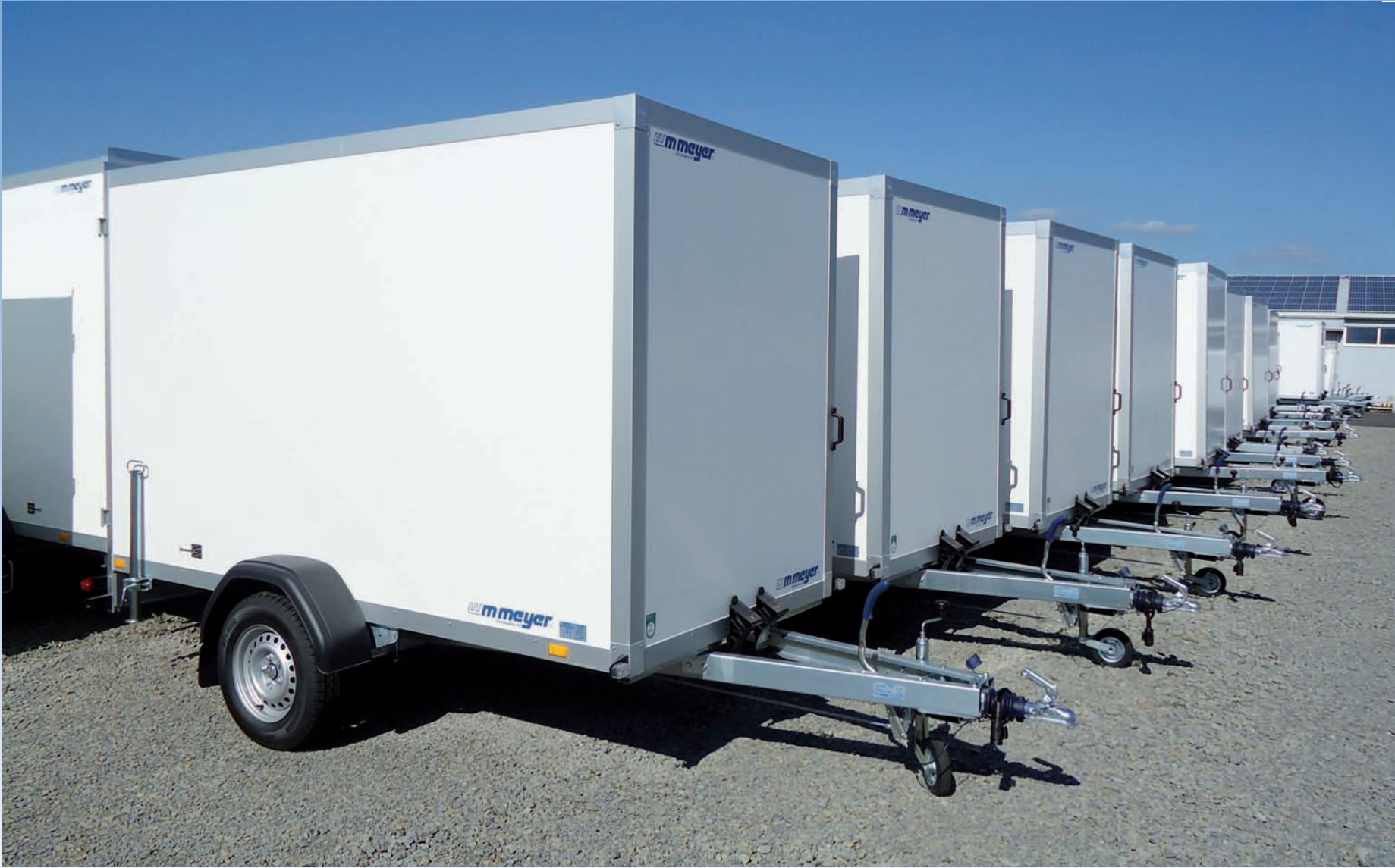
AZ 1330/151 Serie 40 V-Deichsel verzinkt, Aluminiumprofil, Aufbau Sandwichpolyester AZ 1330/151 Série 40 Timon en V galvanisé, profilés en aluminium, panneaux polyester sandwich AZ 1330/151 Series 40 Galvanised V drawbar, aluminium profiles, sandwich polyester panels
