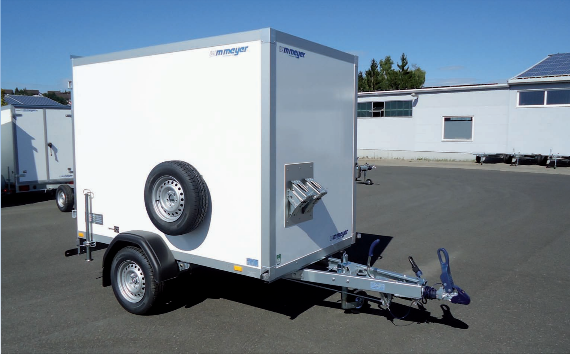
AZ 1325/151 Serie 70 Zubehör: Antischlingerkupplung, Lüftungslamelle, Unterlegkeile, Ersatzrad AZ 1325/151 Série 70 Options : stabilisateur pour tête d'attelage, aération, cales de roue, roue de secours AZ 1325/151 Series 70 Optional extras: sway-control coupling, ventilation vent, wheel chocks, spare wheel
