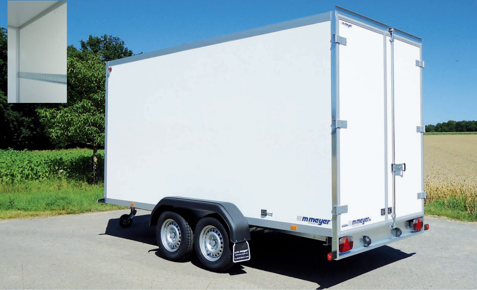
AZ 2740/185 Serie 35 Verstärkungen mit Filzstift angezeichnet; kleines Bild: Zurrleiste (Serie bei Innenlänge von 3.010 mm) AZ 2740/185 Série 35 Renforts indiqués avec stylo à feutre ; petite image : rail de fixation (en série : longueur intérieure de 3.010 mm) AZ 2740/185 Series 35 Reinforced sections indicated with felt pen; small picture: lashing rail (standard for interior length of 3,010 mm)
