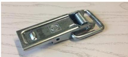
**Bordwandverschluss, verzinkt** mit Rundbügel, Totallänge 150mm Breite ohne Bügel 30mm, Lochabstand 22mm
