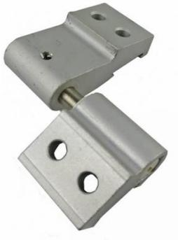
**Türscharnier Aluminium eloxiert für Pferdanhänger Seitentüren.** Scharnierlänge 83mm Bolzendicke 9mm, Schraubenlochgrösse 8mm Abdeckchieber für Schraublöcher
