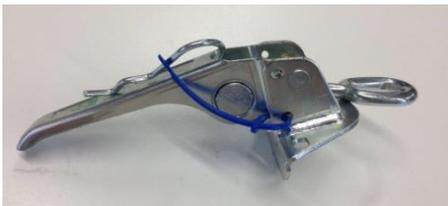
**Excenterverschluss verzinkt mit Spannöse,** Grifflänge 140mm, Totallänge bis Ende Winkelplatte 190mm, Lochabstand 67mm. Winkelauflage 90x45mm, Winklelanschlag 90x37mm.
