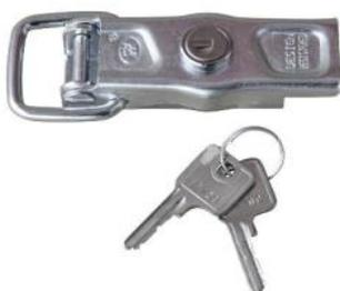
**Bordwandverschluss verzinkt mit Rundbügel abschliessbar,** Schloss und 2 Schlüssel. Totallänge 105mm, Breite ohne Bügel 30mm, Lochabstand 20mm.
