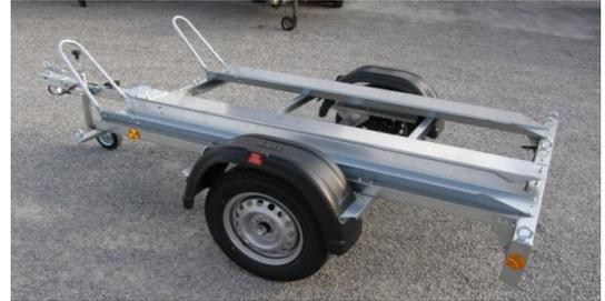
Tiefladeanhänger 1-Achser, verzinkte Gummifederachse, Beleuchtung im Lichtbalken geschützt, 12 Volt. GG 750kg ungebremst, Stützrad. Standschiene kann von aussen in die Mitte versetzt werden. Montage 3. Schiene möglich. Diverse Binderringe zum Sichern der Motorräder. Gesamtbreite ca. 159cm
