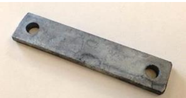
2-Lochplatte feuerverzinkt 8mm dick, Plattengrösse 180x30mm Lochabstand 152mm, Lochgrösse 11mm Miet-Lift Art. Nr. 50396
