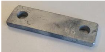
2-Lochplatte feuerverzinkt 8mm dick, Plattengrösse 120x30mm Lochabstand 92mm, Lochgrösse 11mm Miet-Lift Art. Nr. 50393
