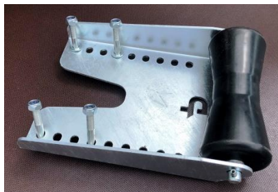
Kielrollenhalter Pongratz Gr. 1 für Quer- träger, feuerverzinkt. Höhe Befestigungsprofil ca. 290mm, Breite ca. 220mm Lochgrösse 11mm. Inkl. 2 Befestigungs U-Bügel M10, Abstand Schraubenmitte ca. 75mm Schraubenlänge ca. 65mm Miet-Lift Art. Nr. 50234
