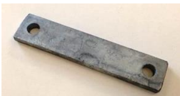
2-Lochplatte feuerverzinkt 8mm dick, Plattengrösse 160x30mm Lochabstand 132mm, Lochgrösse 11mm Miet-Lift Art. Nr. 50395
