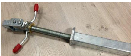
Spindelstütze für Boots-Seitenauflagen oder Doppelrollen, Stahl feuerverzinkt. Aussendurchmesser 4-Kantrohr 50x50mm. Rohrlänge 260mm, Verstellhöhe 21cm. 4-Kantaufnahme 40x40mm, Lochabstand 25mm, Lochgrösse 11mm. Totallänge eingekurbelt 420mm. Aufnahmekopf für Gummiauflage 35x35mm. Miet-Lift Art. Nr. 50250
