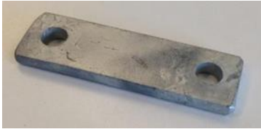
2-Lochplatte feuerverzinkt 8mm dick, Plattengrösse 110x30mm Lochabstand 82mm, Lochgrösse 11mm Miet-Lift Art. Nr. 50392
