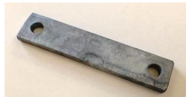
2-Lochplatte feuerverzinkt 8mm dick, Plattengrösse 140x30mm Lochabstand 112mm, Lochgrösse 11mm Miet-Lift Art. Nr. 50394
