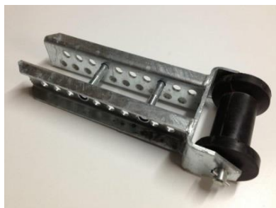
Kielrollenhalter Gr. 1, feuerverzinkt, komplett. Höhe Befestigungsprofil 260mm, Breite Lochprofil 62mm, Innenbreite 51mm für 50mm-Rahmen, inkl. Rolle 168mm und Achse Miet-Lift Art. Nr. 50231
