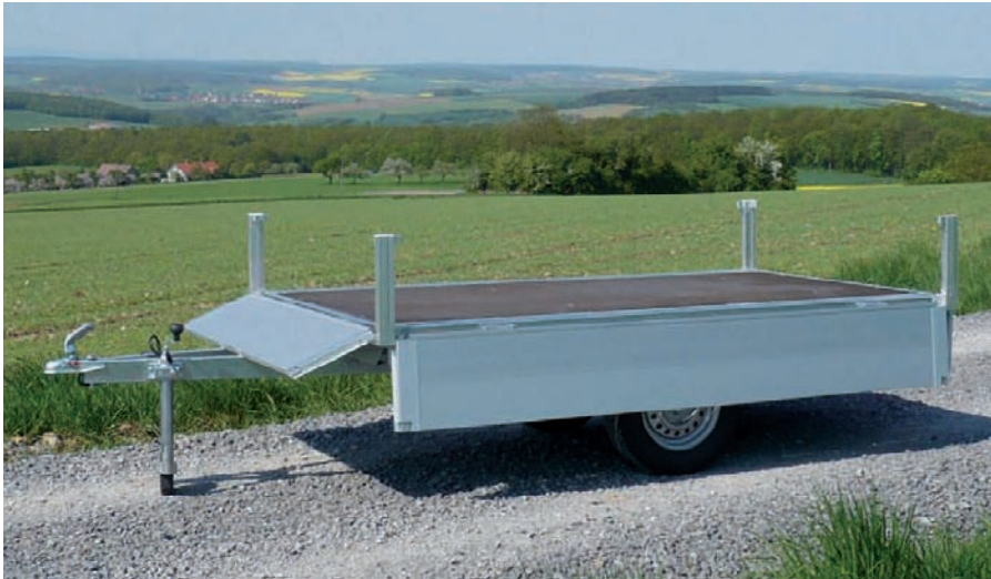
HLN 7525/151 Alle Bordwände klappbar HLN 7525/151 Toutes les ridelles ouvrables HLN 7525/151 All side panels can be opened
