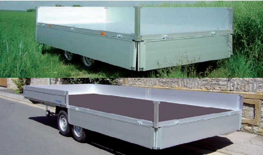
Oben: HLC 2746/186 Aufpreis: Aluprofilboden; unten: HLC 3560/244 Bordwände zum Öffnen und abnehmbar, Mittelrungen Au-dessus : HLC 2746/186 Avec supplément : plancher en alu ; au-dessous : HLC 3560/244 Ridelles ouvrab. / amovibles, ranchers centraux Top: HLC 2746/186 With extra charge: aluminium platform; bottom: HLC 3560/244 All side panels can be opened and removed, centre posts
