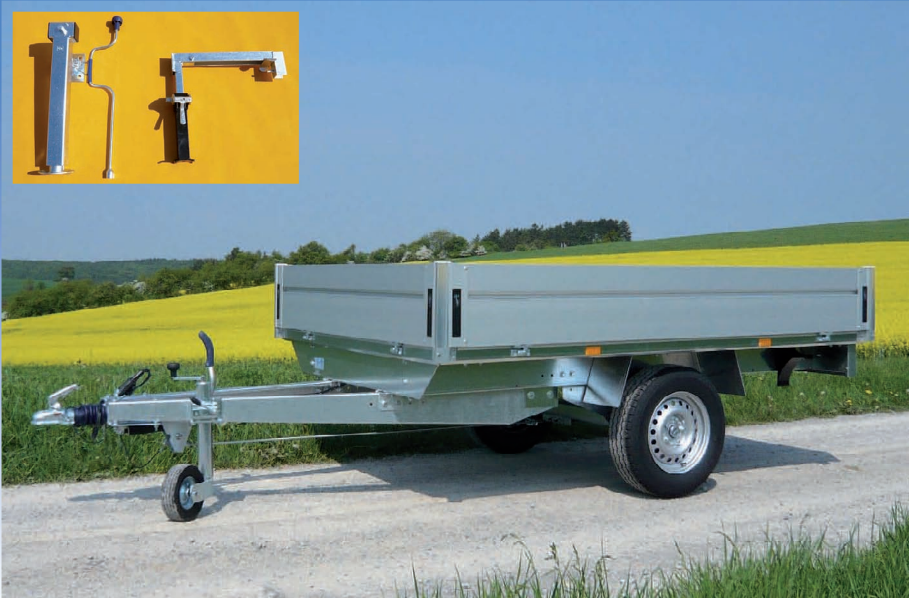
HLC 1326/170 Alubordwände eloxiert; kleines Bild: Klappkurbelstütze (links), Automatikstütze (rechts) HLC 1326/170 Ridelles en alu anodisé : petite image : béquille à relever avec manivelle (à gauche), béquille automatique (à droite) HLC 1326/170 Anodised aluminium side panels ; small picture: prop stand to be folded away, with crank (left), automatic prop stand (right)
