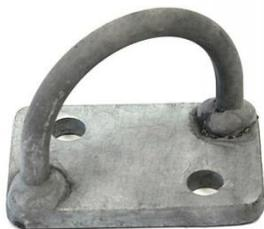
**Zurrbügel Stahl feuerverzinkt auf Platte verschweisst. Plattengrösse 80 x 50 x 8mm Bohrlöcher M10. Zugkraft 800daN. Bügelbreite Bügelbreite innen 45mm, Innenhöhe 60mm**
