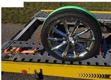
**Fahrzeugsicherung Zurrgurte 1-teilig**
