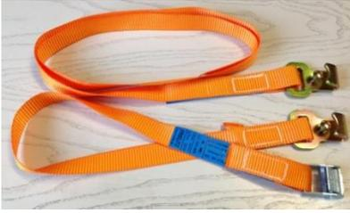
**Zurrurt für Stäbchenzurrutsche 2-teilig** mit Klemmschloss. Bandbreite 25mm, L 2m, Direktzug 125kg / Umreifung 250kg.
