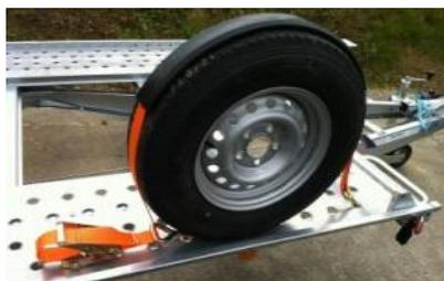
**Fahrzeugsicherung Zurrgurte 2-teilig**
