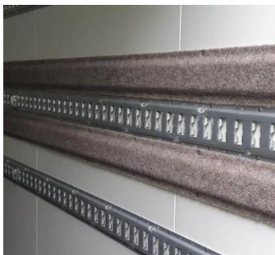
**Teppichschiene Stahlprofil ohne Bohrlöcher**
