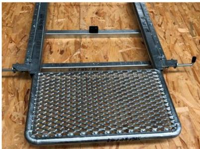
**Ausziehtritt 30 x 60cm feuerverzinkt für nachträgliches anbauen.** Totallänge mit eingeschobenem Tritt 1060mm, Breite Montageprofil von links nach rechts 675mm, Lochabstand von links nach rechts ca. 648mm, Länge Montagewinkel 720mm, Totalhöhe 80mm. Arretierung mit 2 Federriegel (keine Löcher vorgebohrt). Ohne Befestigungsmaterial. Gewicht 17kg
