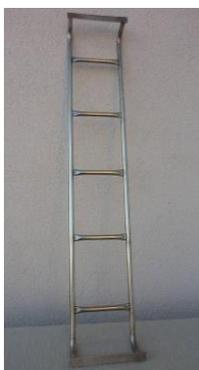
**Aufstiegleiter 5-stufig aus rostfreiem Chromstahl mit verschweissten Tritten.** Länge 140cm, Breite 25cm, Höhe 11cm. Ohne Bohrlöcher.
