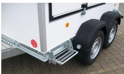
**Klapptritt 1-stufig für Einbau unter Türen** Stahl feuerverzinkt., lose inkl. Standard-Befestigungsschrauben. Trittgröße 340 x 160cm ohne Befestigungsplatten oder Adapterplatten
