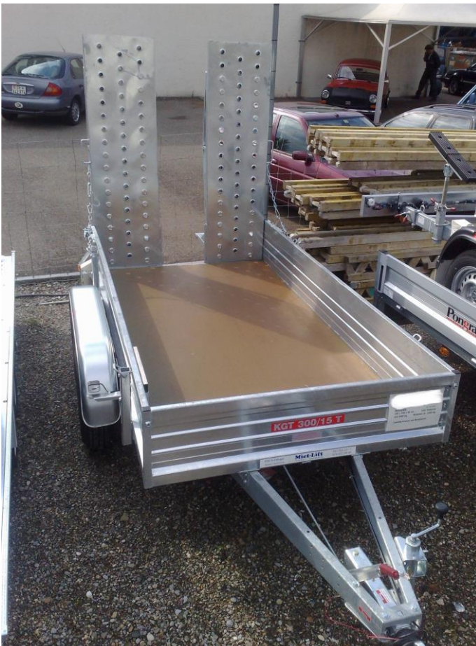
Stahlaufharrampen mit Lochprofil, seitlich verstellbar
