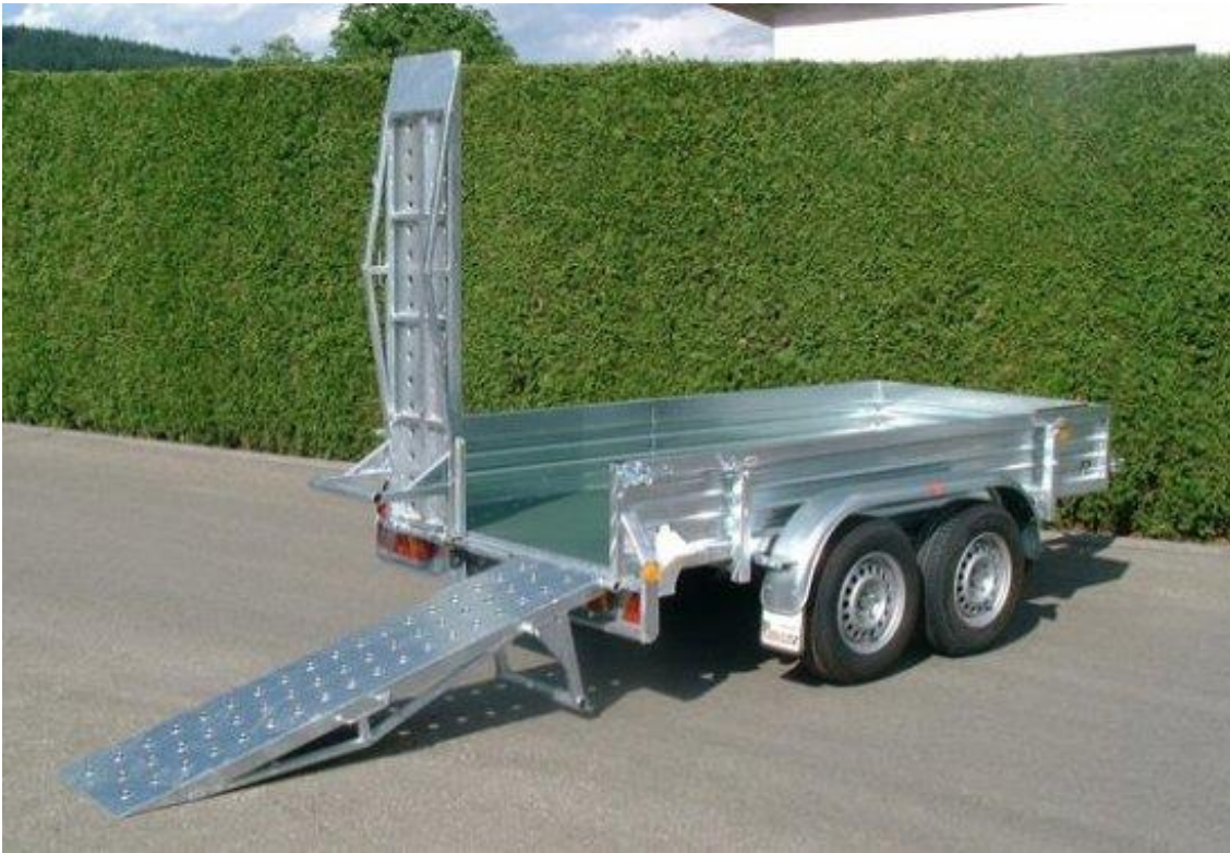
Kleinbaggeranhänger KGT 301 x 150 x 40cm, Stahlwände verschweisst und feuerverzinkt
