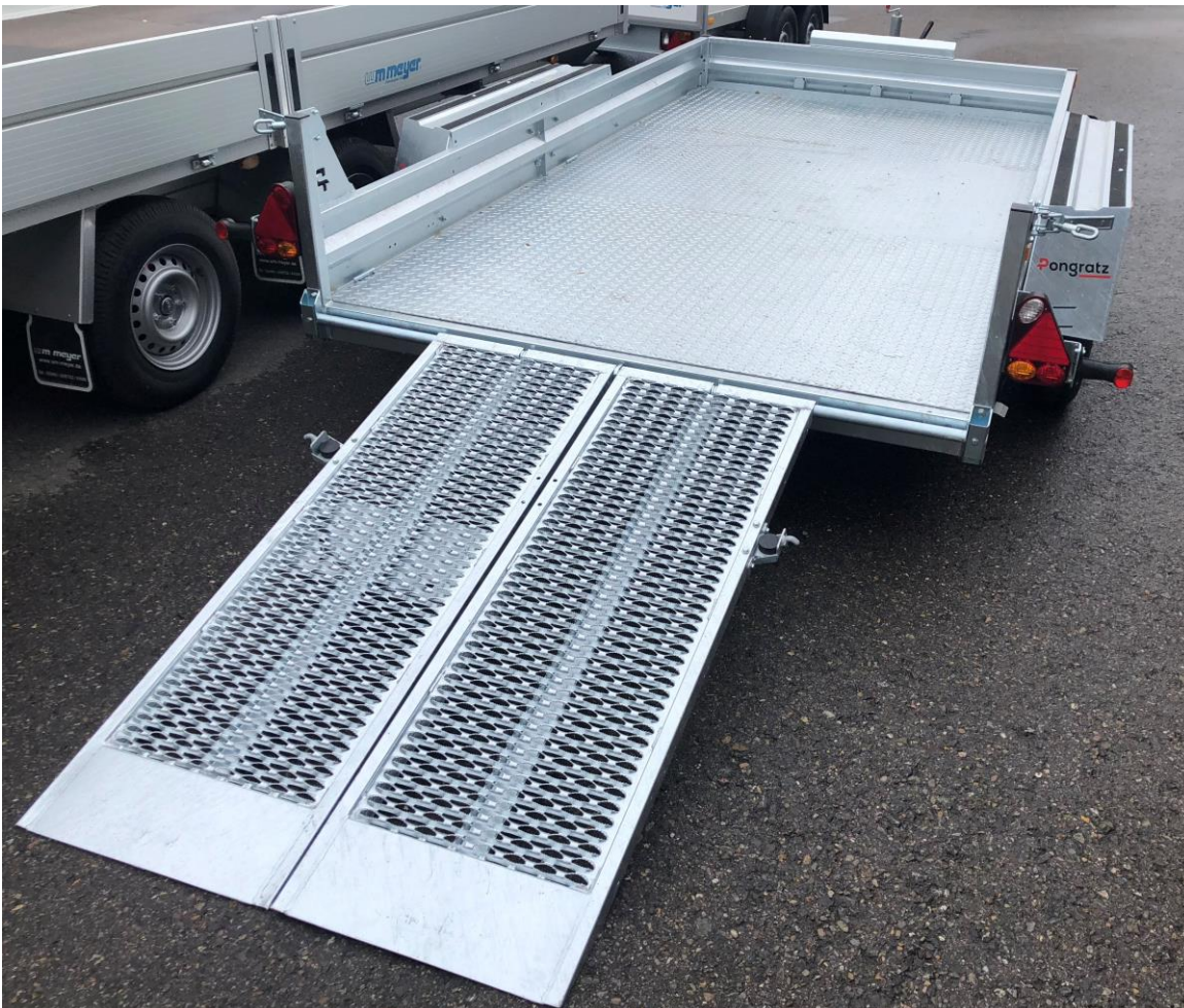
Seitlich verschiebbare Stahlrampen mit sehr griffiger Streckmetalloberfläche
