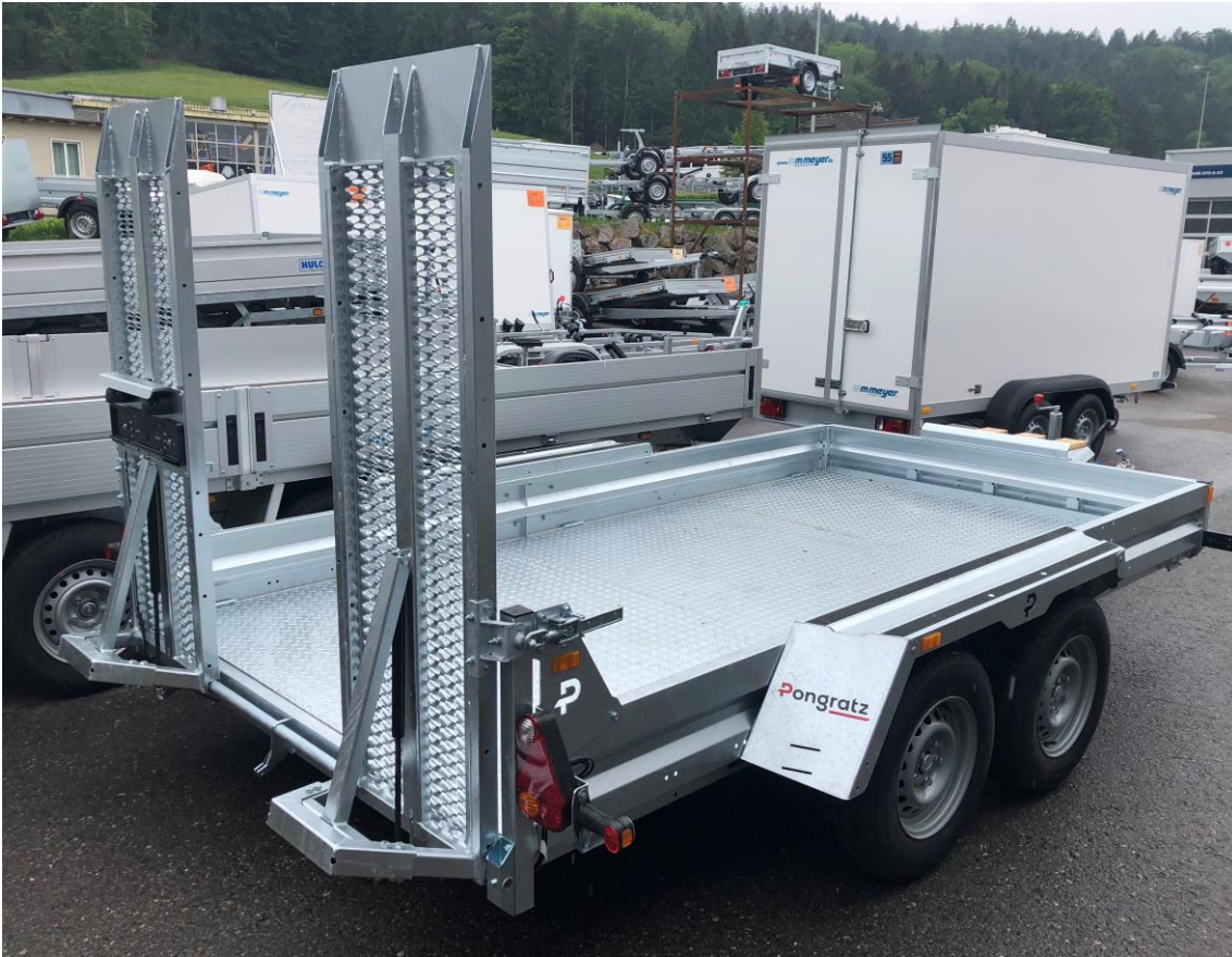
PMT 360/18 T, 365 x 187 x 26cm, GG 3500kg, Stahrriffelboden
