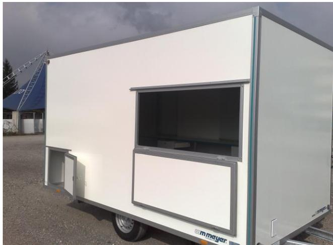
Serviceklappe an Rückwand
