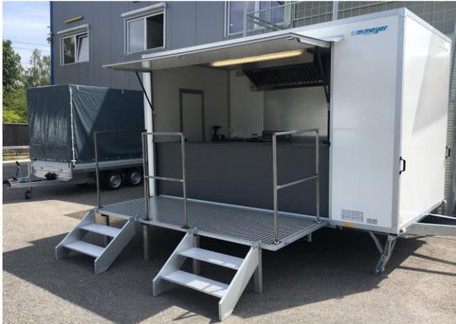
Ausklappbares Podest mit Treppen und Geländer (variabel einsetzbar), Hochladerausführung
