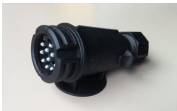
Stecker Kunststoff 13-polig 12V steckbar (nicht zum Eindrehen) mit 13 Schraubanschlüssen Ausgangsdichtung für zwei Rundkabel
