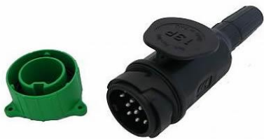
Stecker Kunststoff 13-polig 12 V Bajonettverschluss (keine drehbare Aussenhülle) mit 13 Schraubanschlüssen Ausgangsdichtung für 2 Rundkabel
