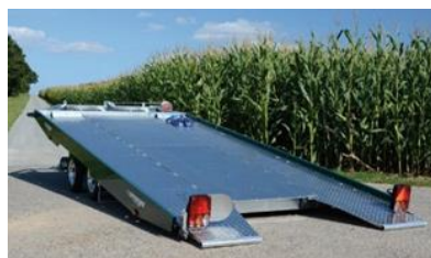
Boden geschlossen mit Aluriffelblech
