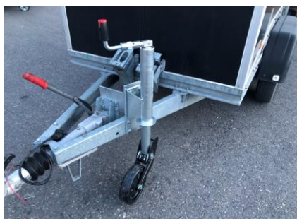
Stützrad 900kg mit Flanschplatte
