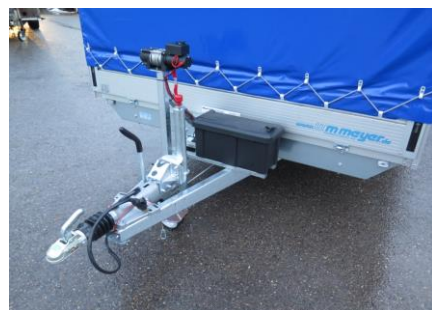
Elektro-Seilwinde auf Bock montiert
