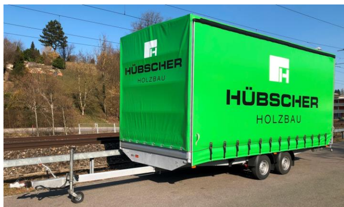
Schiebeblache mit Gurtverschlüsse, verlängerter Deichsel, Werbedruck
