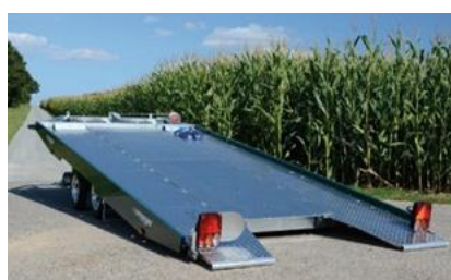
Boden geschlossen mit Aluriffelblech
