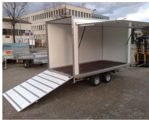
Hochlader mit Niederfahrwerk
