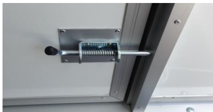
Verschluss Klappe Innenseite
