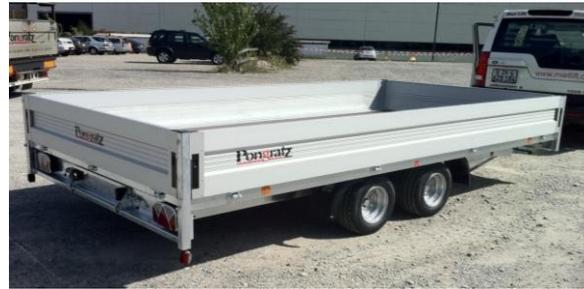
**PHL 4030/20 mit Niederfahrwerk + Rampenschacht**
