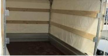
**Holzlatte für Blachenaufbau 116x25mm**
