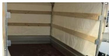
**Holzlatte für Blachenaufbau 116x25mm**
