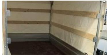
**Holzlatte für Blachenaufbau 116x25mm**
