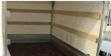
**Holzlatte für Blachenaufbau 116x25mm**
