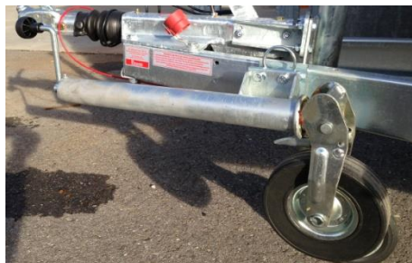
Schwenkvorrichtung für Stützräder, belastbar bis 500kg, schwenkbar um 90°, feuerverzinkt. Grundplatte 100x100mm, Dicke 12mm. Lochabstand 50x70mm, Lochdurchmesser 10,5mm. Dicke der beiden Platten ca. 68mm, Bolzendicke 16mm. Miet-Lift Art. Nr. 52138
