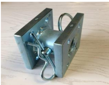
Schwenkvorrichtung für Stützräder, belastbar bis 500kg, schwenkbar um 90°, feuerverzinkt. Grundplatte 100x100mm, Dicke 12mm. Lochabstand 50x70mm, Lochdurchmesser 10,5mm. Dicke der beiden Platten ca. 68mm, Bolzendicke 16mm. Miet-Lift Art. Nr. 52138
