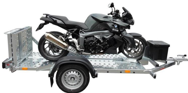
Tieflader 1-Achser ungebremst, verschweisster und feuerverzinkter Rahmen. Stahlblechboden mit Bindelöcher, Motorradwippe verstellbar in Grösse und Position. Verschiedene Bindebügel. Faltbare Auffahrrampe für flachen Auffahrwinkel. Verzinkte Gummifederachse, Stützrad.
