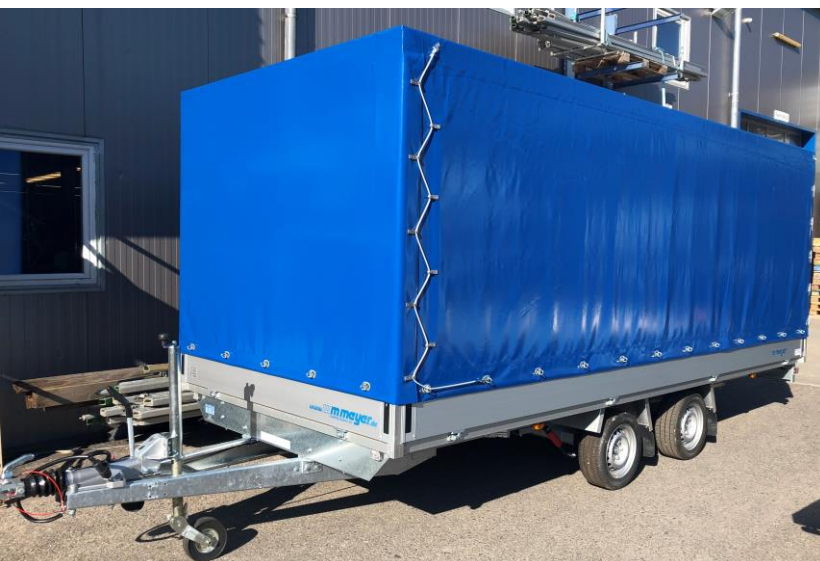
--Ringsum Drehverschlüsse, seitlich Schleuderverschluss (Sonderausführung, Mehrpreis)
