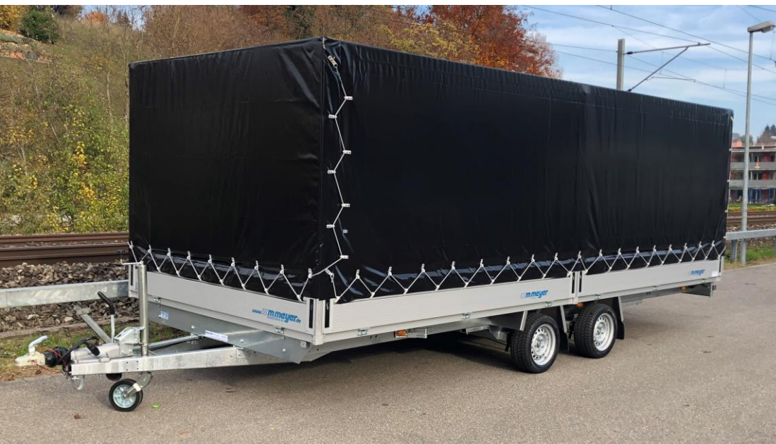
Gummiseil und Kunststoffhaken zum Einhängen in Bordwände (Standardausführung)
