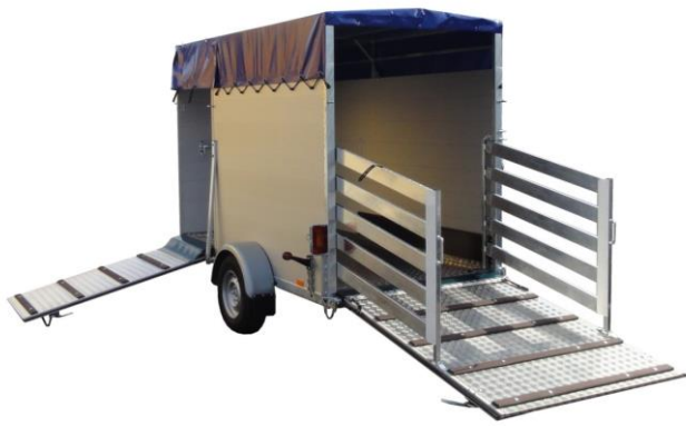
Rampenfläche mit Alu-Riffelblech und Holztrittleisten
