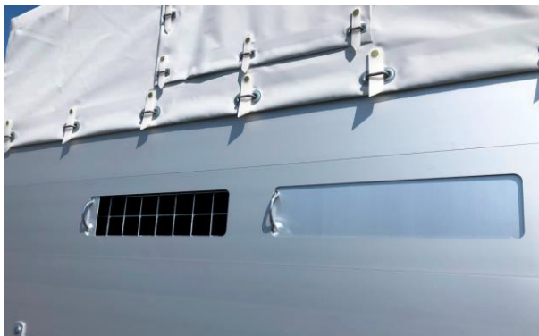
Lüftungsgitter in Stinwand, Aussenansicht
