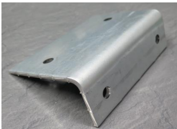
Befestigungsplatte für Klemmschelle Stahl verzinkt. Länge 150mm, Breite 100mm Winkel 50mm, Dicke 5mm. Lochabstand 105mm Lochabstand 105mm, Lochgrösse 11mm. Miet-Lift Art. Nr. 52128
