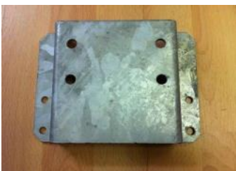
Halterung für Stützradklemme Anbau seitlich an Deichselholmen Lochmass Deichsel 185x40mm, Ø 8mm Lochmass Klemmschelle 105x45mm, Ø12mm Miet-Lift Art. Nr. 52155
