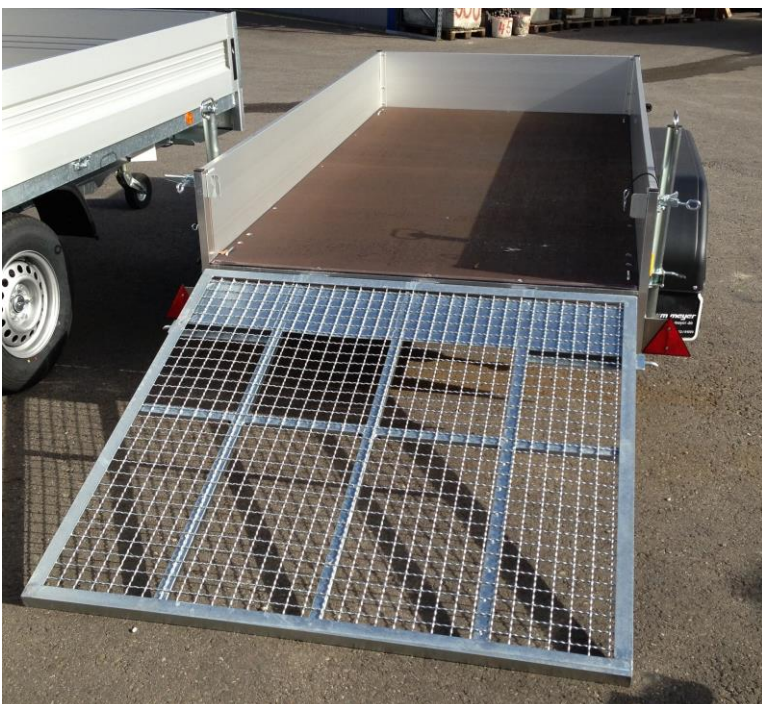
Giterrampe 550kg belastbar, Rohrstützen, Laubgitter
