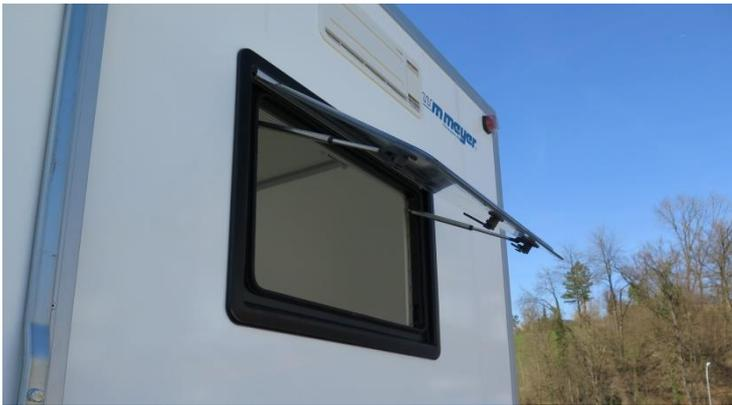
**geöffnetes Fenster hält mit Hebedämpfer**
