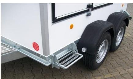
**Klapptritt 1-stufig für Einbau unter Türen**
