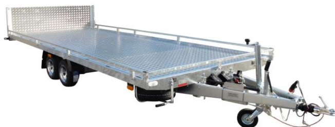
Reling statt Aluwände, Aluriffelblech auf Holzboden
